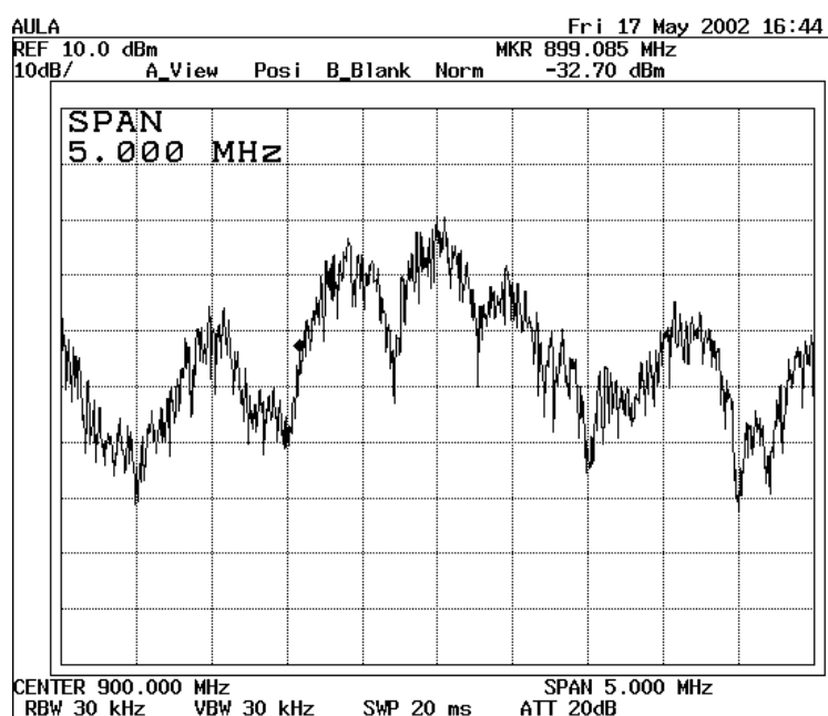
Figura 5.16. Pode-se perceber 3 nulos na banda do sinal. Nesses pontos se torna praticamente inviável a recuperação correta do sinal transmitido sem uma contramedida.
