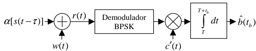
Figura 2.10 – Diagrama em blocos do receptor DS-SS.
