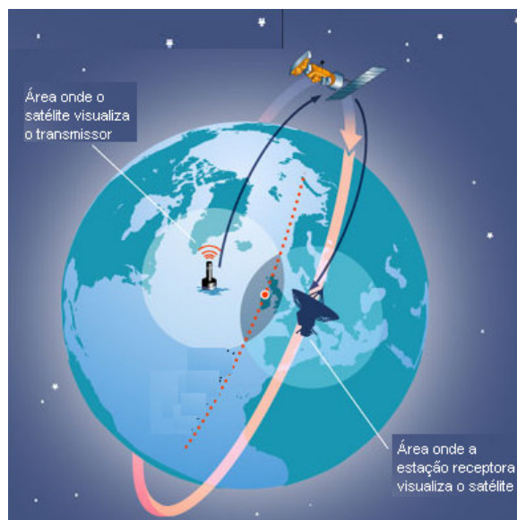
Figura 1: Funcionamento do sistema Argos em tempo real [14]
