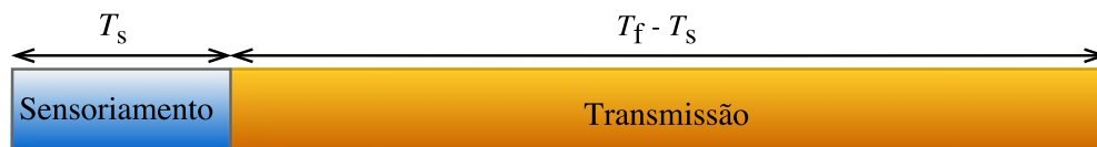
Figura 3.1: Estrutura do quadro de sensoriamento-transmissão.
