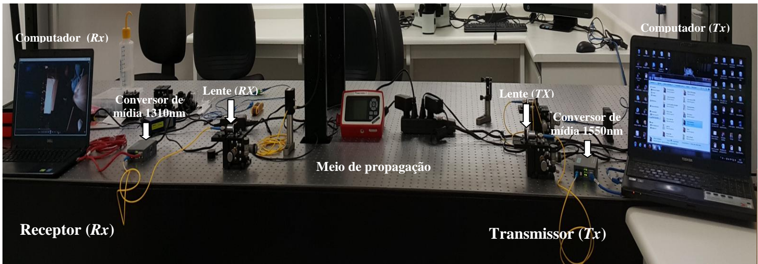
Fig. 5.2. Troca de informação entre dois computadores através do espaço aberto utilizando conversores de mídia.
