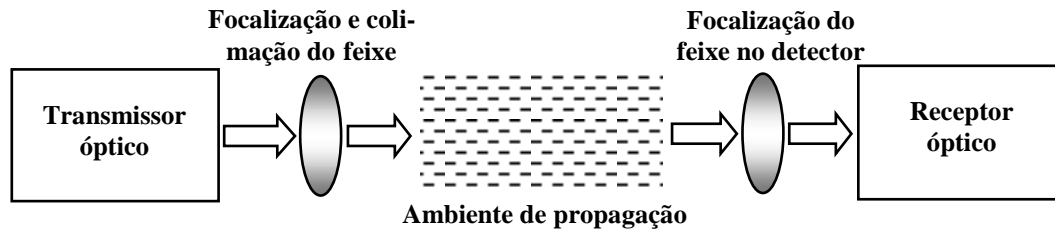
Fig. 2.1. Esquema de um enlace de comunicações ópticas em ambiente aberto, com apresentação de algumas partes relevantes no processo.
