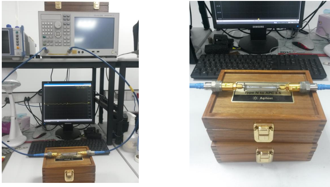
Fig. 3.11. Montagem do balun simétrico construído para levantamento dos coeficientes S_{11} e S_{21} com o VNA Agilent E5071C.
