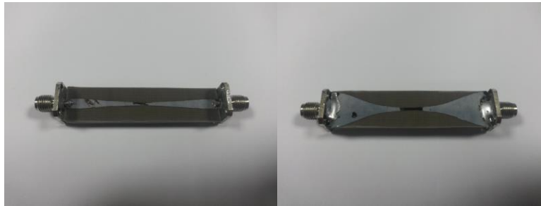
Fig. 3.10. Protótipo do balun simétrico, com a vista superior e inferior da microlinha.
