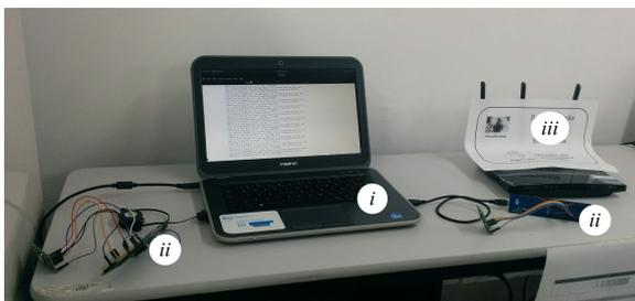
Figura 5.1: Cenário Experimental 1: (i) Núcleo NovaGenesis e aplicação cliente IoT (IoTTestApp) rodando no computador; (ii) dois EPGSes NovaGenesis rodando em *hardwares* NXP-LPC1769 na direita e na esquerda (cabo USB somente para energia); (iii) Ponto de acesso Wi-Fi.
