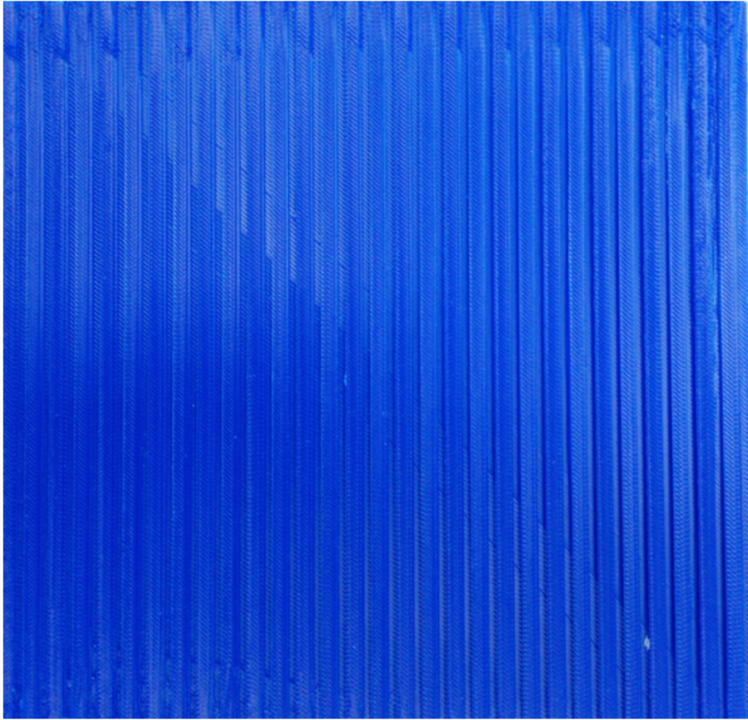
Figura 4.20 – FSS totalmente dielétrico impressa com uma impressora 3D.
