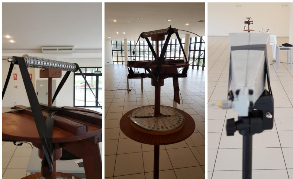
Figura 3.26 – Cenário para medida dos diagramas de radiação do SWAA_Bars.
