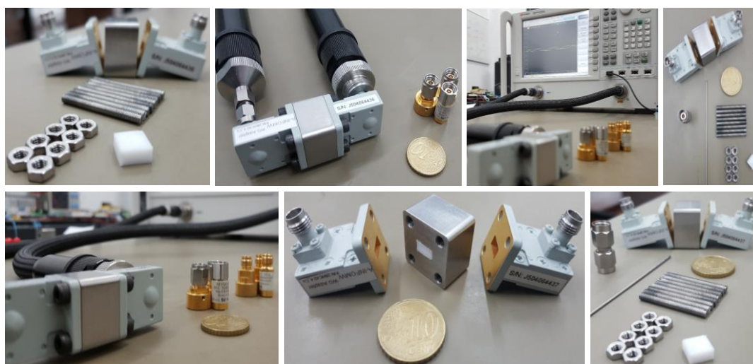
Figura 2.11 - Cenário utilizado para realização da caracterização do teflon.
