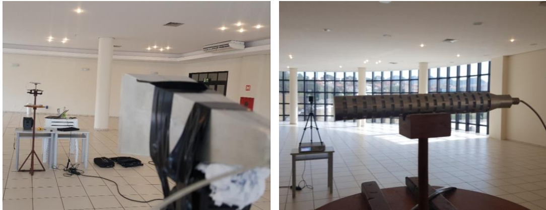
Figura 3.19 – Cenário para medida dos diagramas de radiação do SWAA_Twist.
