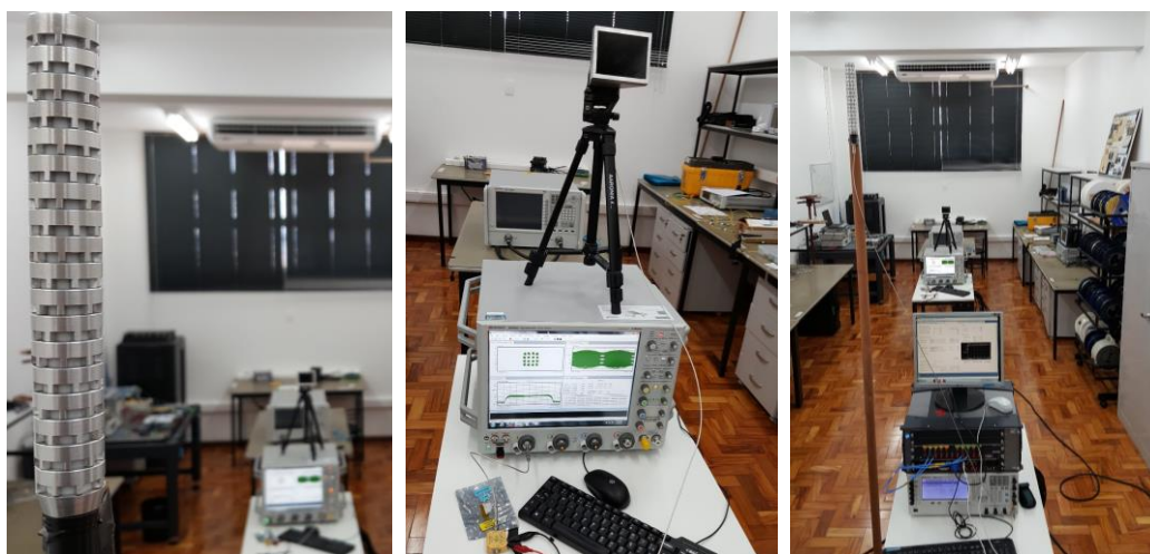
Figura 4.2 – Cenário das medidas de desempenho em 24,15 GHz utilizando o SWAA_Twisted .
