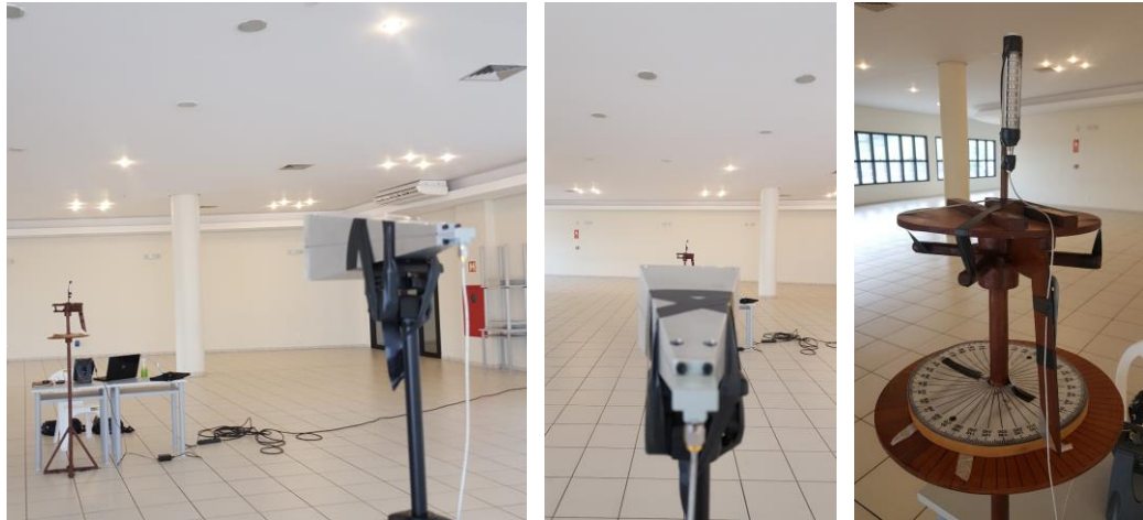
Figura 3.9 – Configuração de medidas de diagrama de radiação do SWAA_Jacket.
