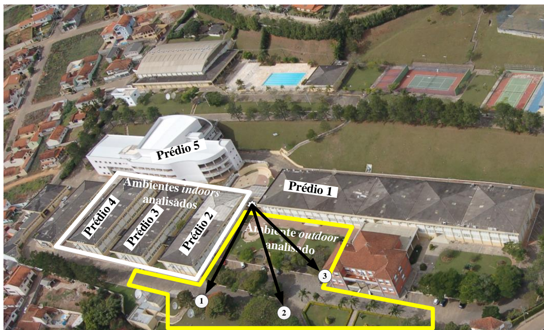
Figura 4.5 – Ambiente outdoor das medições da perda de percurso e do coeficiente de propagação.
