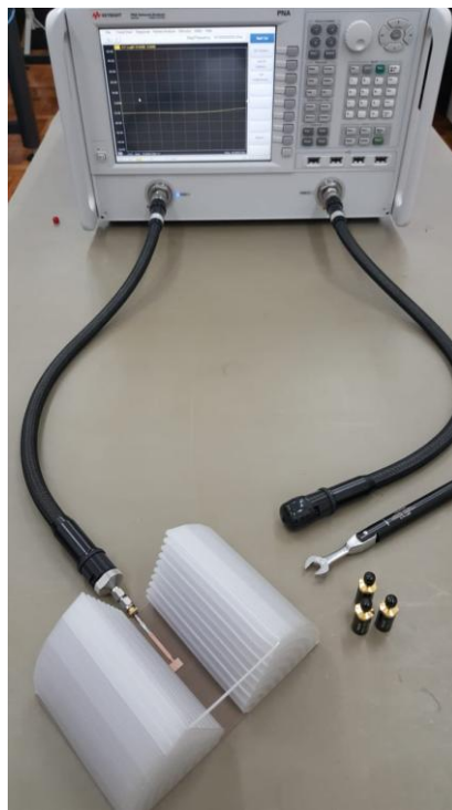
Fig. 5.11. Montagem para a medição do coeficiente de reflexão da antena de microfitas com inclusão dos espelhos de Bragg sobre o substrato.
