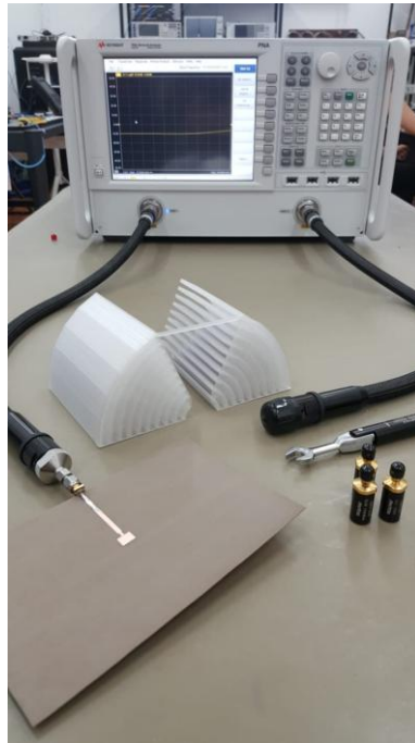
Fig. 5.5. Montagem para a medição do coeficiente de reflexão da antena de microfita.
