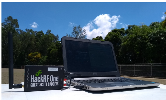
Figura 3.3: Hardware usado para abrigar a célula de sensoriamento e firmware Channel Advisor .
