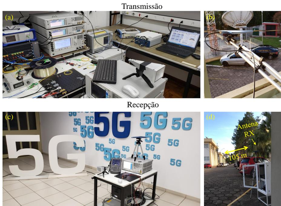
**Figura 4.12:** Fotografias do cenário de medida de desempenho do sistema FiWi multi-bandas: (a) sistema FiWi multi-banda; (b) transmissão do sinal em 788 MHz; (c) recepção do sinal em 26 GHz a 10 m; (d) recepção do sinal em 788 MHz a 105 m.
