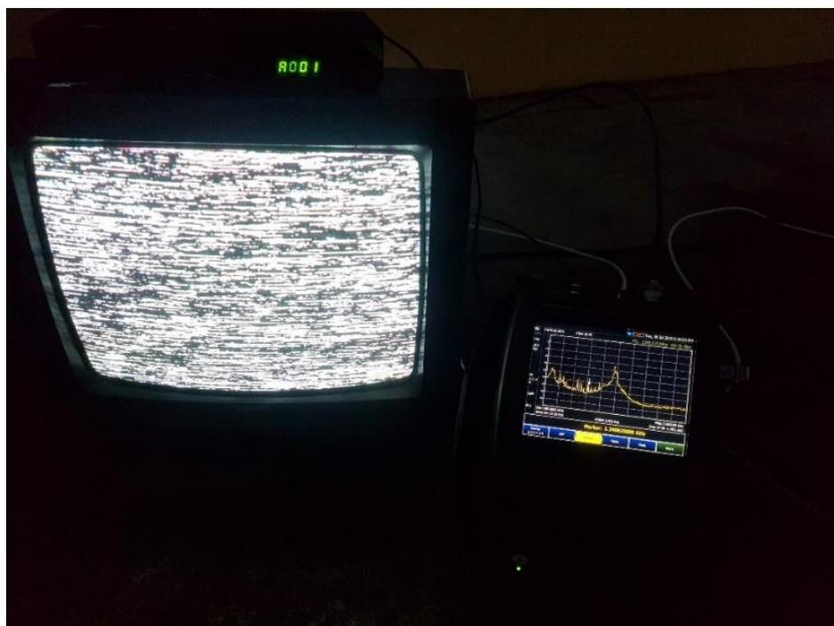
**Figura A.13** – Imagem da TV em canal analógico com sinal interferente acima do limiar suportado pelo LNBF.
