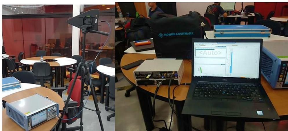
(b) gerador de sinais 5G NR e equipamentos do walk test na banda de 700 MHz.
