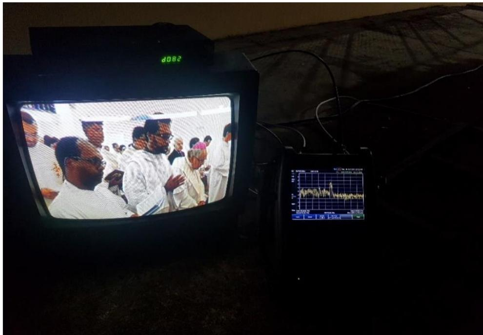
**Figura A.12** – Imagem da TV em canal digital com sinal interferente.
