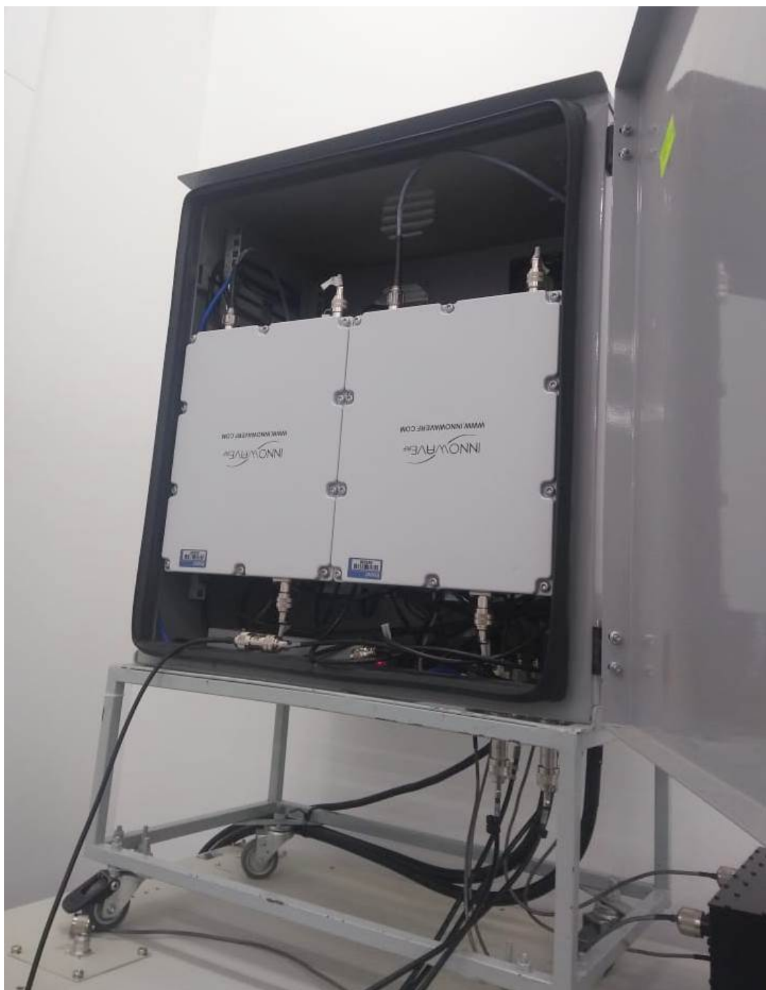
Figura B.1: Hardware do rádio do transceptor TX-RX-MIMO-GFDM (Modem 5G).
