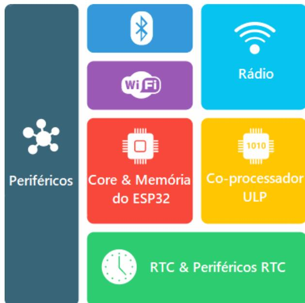
Figura 5.8: Principais módulos de consumo de energia do ESP32.
