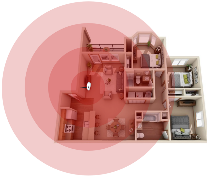
Figura 1.2: Cobertura em uma residência da emissão de um dipolo com polarização vertical, com o ponto de acesso instalado próximo à parede, distribuindo parte do sinal fora da região de interesse.
