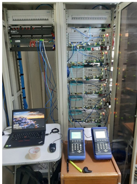
Figura 3.14: Cenário 2 com estrutura física de equipamentos CISCO.
