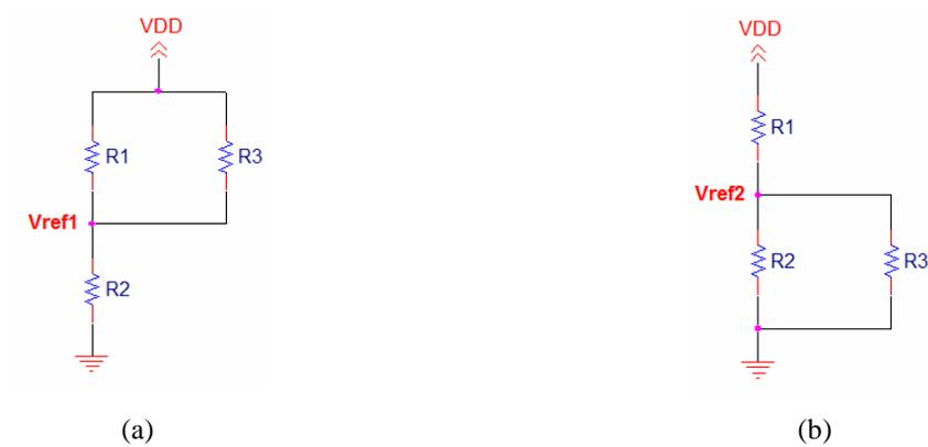
**Figura 4.15** - Alteração do divisor resistivo responsável pelo nível de comparação devido à presença de histerese no comparador. (a) Divisor resistivo para nível de comparação igual a  $V_{ref1}$ . (b) Divisor resistivo para nível de comparação igual a  $V_{ref2}$ .
