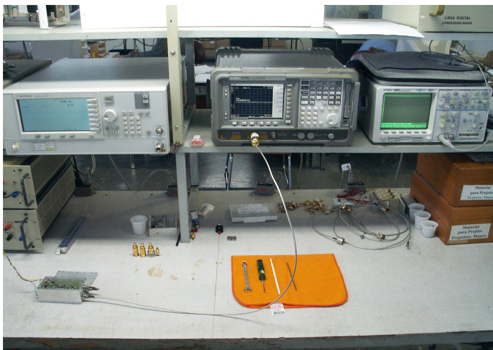
Figura 3.3 – Foto do protótipo e das ferramentas usadas na sua análise. O analisador de espectro, o osciloscópio e as fontes de alimentação.
