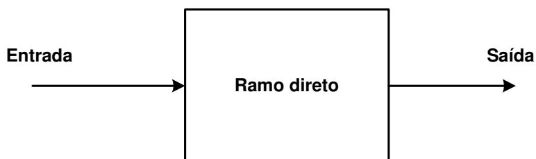
Figura 2.10 – Diagrama em blocos representativo de um sistema de controle de malha aberta.
