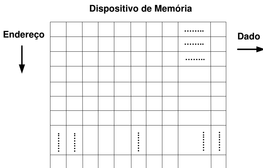
Figura 4.8 – Exemplo de uma memória ideal. Memória que possui infinitos bits de endereçamento e infinitos bits para representar os dados. Neste caso tem-se uma memória capaz de representar com perfeição uma senóide ideal.
