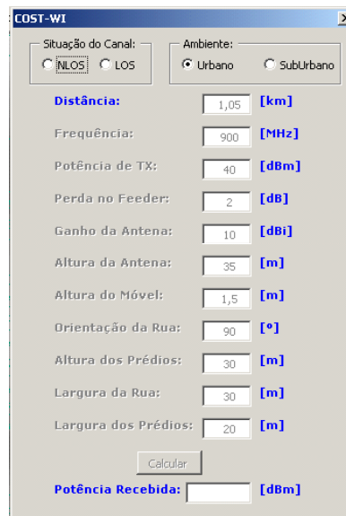
FIGURA 5.20 JANELA PARA CONFIGURAÇÃO DOS PARÂMETROS UTILIZADOS NO MODELO COST-WI
