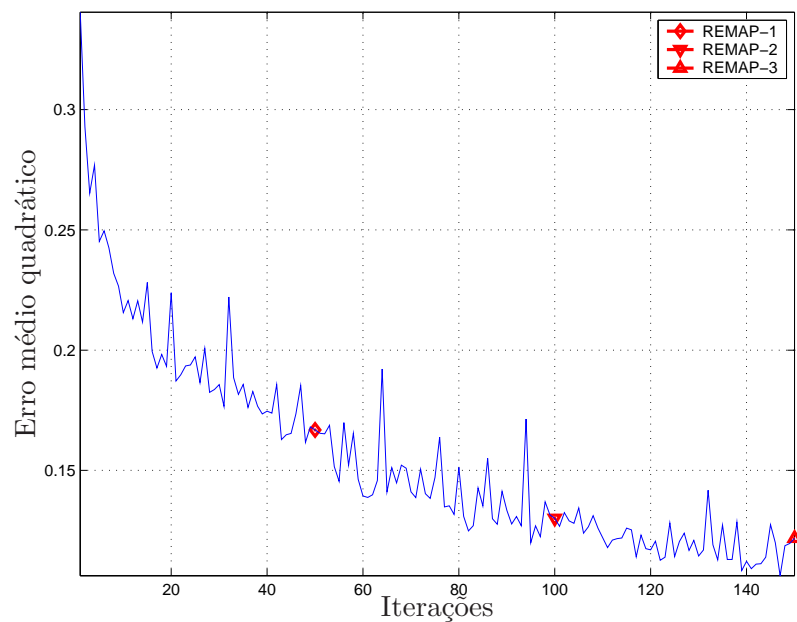
Figura 5.37: Erro médio quadrático. Rede neural de 108 entradas com \eta = 0,1 . Desvio máximo de 10 ms.
