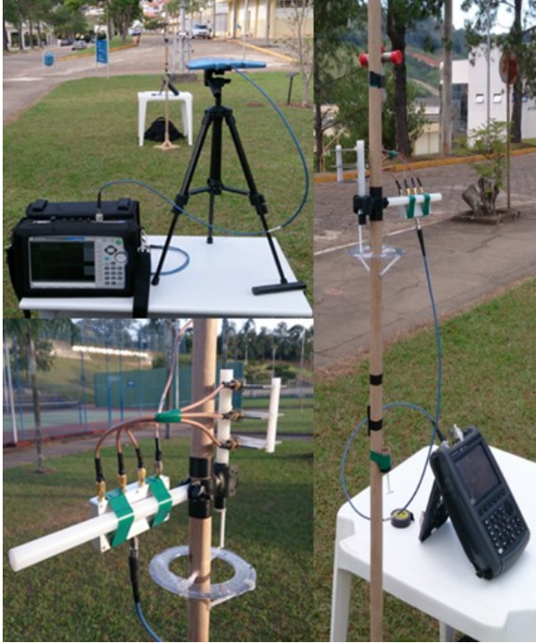
Fig. 3.12. Montagem para medir o diagrama de irradiação do arranjo de antenas empilhadas.
