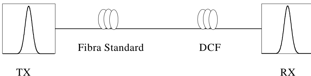
Figura-5-3 - Esquema de um enlace ponto a ponto de 100 km.
